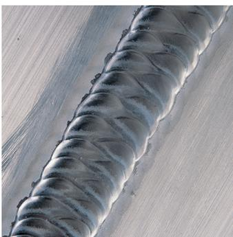
Стыковой шов, полученный в результате TIG сварки алюминиевого сплава 4140 толщиной 10 мм с использованием сварочной смеси Alulinx®.
