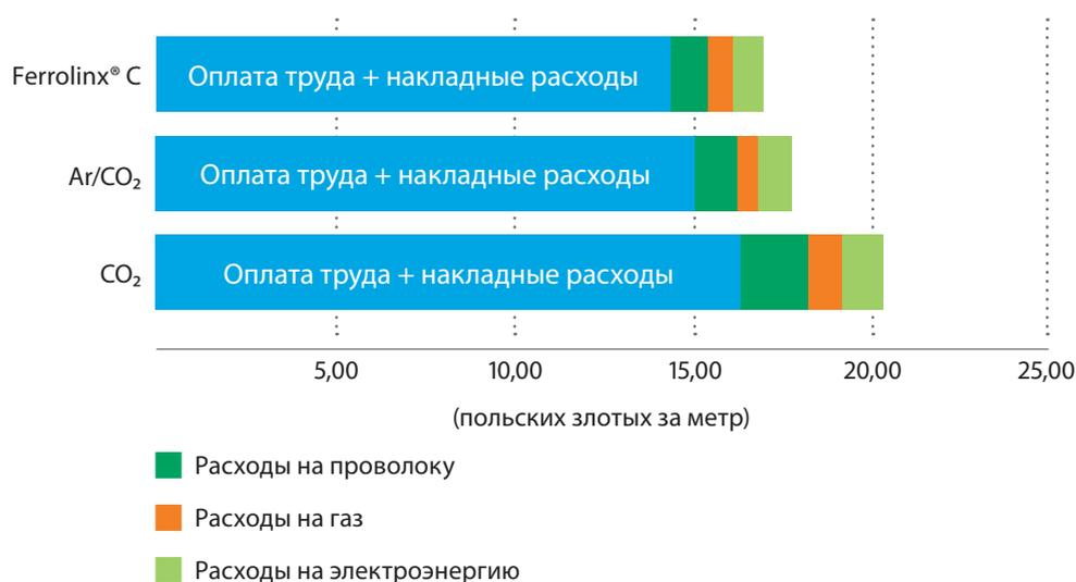
Общая стоимость за 1 м сварного шва – угловой шов, полученный в результате дуговой сварки плавящимся электродом (MAG 135) углеродистой стали толщиной 8 мм в положении РВ.
