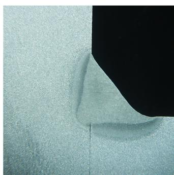
Угловой шов, полученный в результате MAG (135) сварки углеродистой стали толщиной 8 мм в положении РВ с использованием газа Ferrolinx® C.
