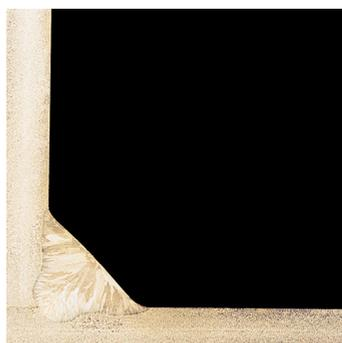
Угловой шов, полученный в результате MAG (135) сварки нержавеющей стали толщиной 3 мм в положении РВ с использованием сварочной смеси Inolinx®.
