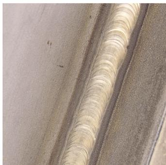
Угловой шов, полученный в результате TIG (141) сварки нержавеющей стали толщиной 3 мм в положении РВ с использованием сварочной смеси Inolinx®.
